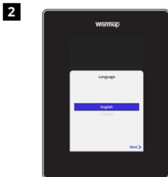
Riattaccare il display finché non si sente un "clic". Ripristinare l'alimentazione del circuito e accendere il termostato. Seguire le istruzioni sullo schermo per impostare il sistema. Una volta impostato, apparirà un codice QR.
