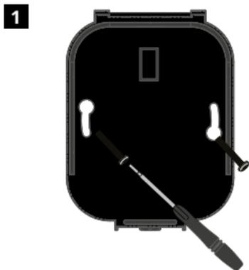
Inserire le viti di fissaggio nei fori di montaggio della base di alimentazione e stringere.
