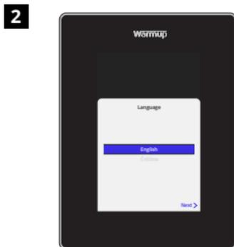
Ponovno pritrdite zaslon, dokler se ne zasliši "klik". Ponovno vključite napajanje v omrežju in vklopite termostat. Za nastavev sistema sledite navodilom na zaslonu. Po nastavitvi se prikaže koda QR.
